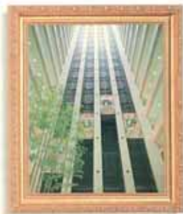
桃園·世貿帝國 (商業綜合大樓) 外型：後側扇型 機種：VF-15人乘×2台 21停站/23樓高 速度：C0105
